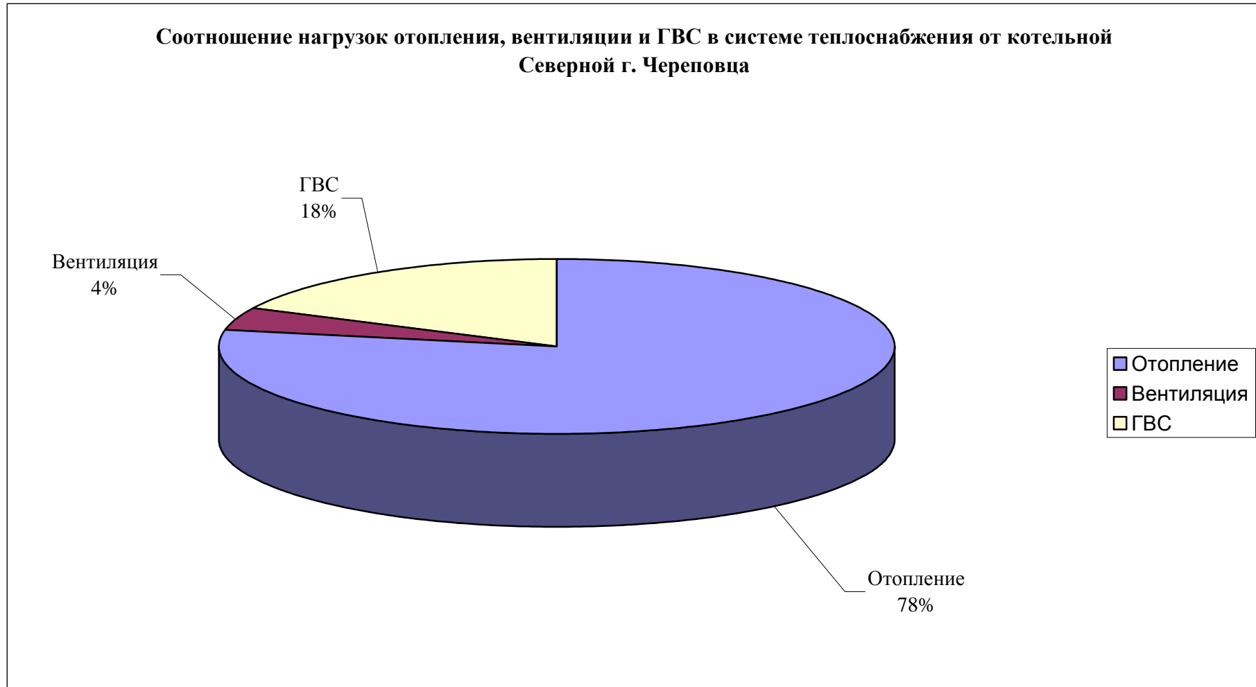
Рис. 1.7 Соотношение нагрузок отопления, вентиляции и ГВС в системе теплоснабжения от котельной Северная
